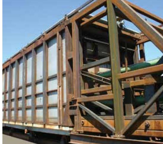
*Modulo sperimentale per la produzione di **Plant Energy** dove la combinazione di insufflazione e pressione meccanica, consente l'ossidazione dei complessi lignoproteici e l'attivazione degli acidi umici.*
